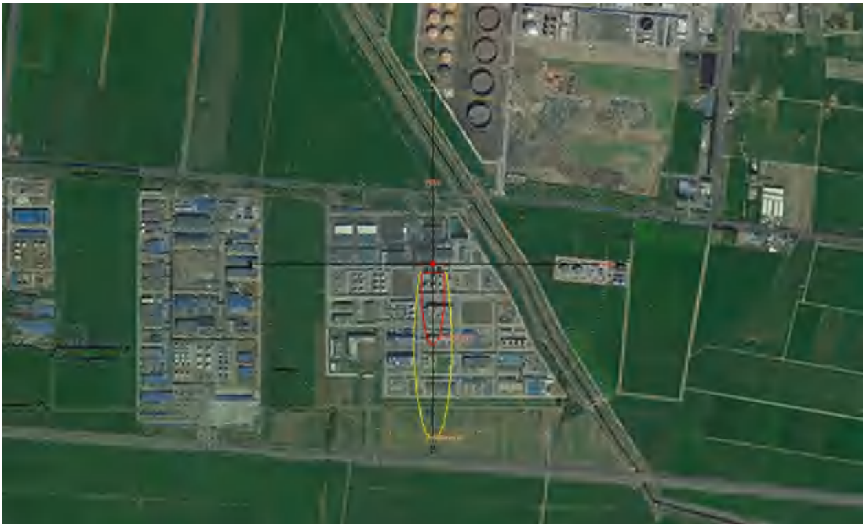
图 6-14 环氧丙烷全破裂泄漏火灾事故有毒有害物质释放最常见气象影响区域图（黄线：终点浓度 2，红线：终点浓度 1）
