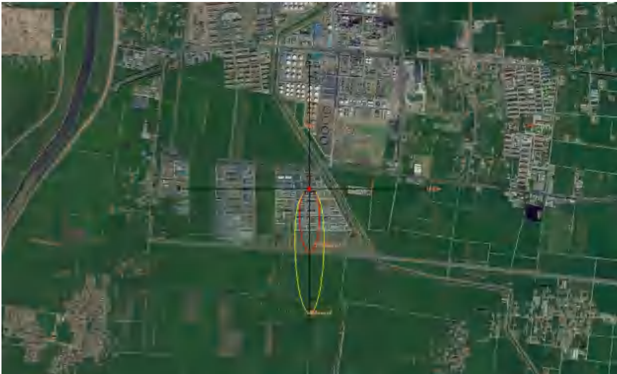
图 6-10 环氧丙烷全破裂泄漏事故最常见气象影响区域图（黄线：终点浓度 2，红线：终点浓度 1）
