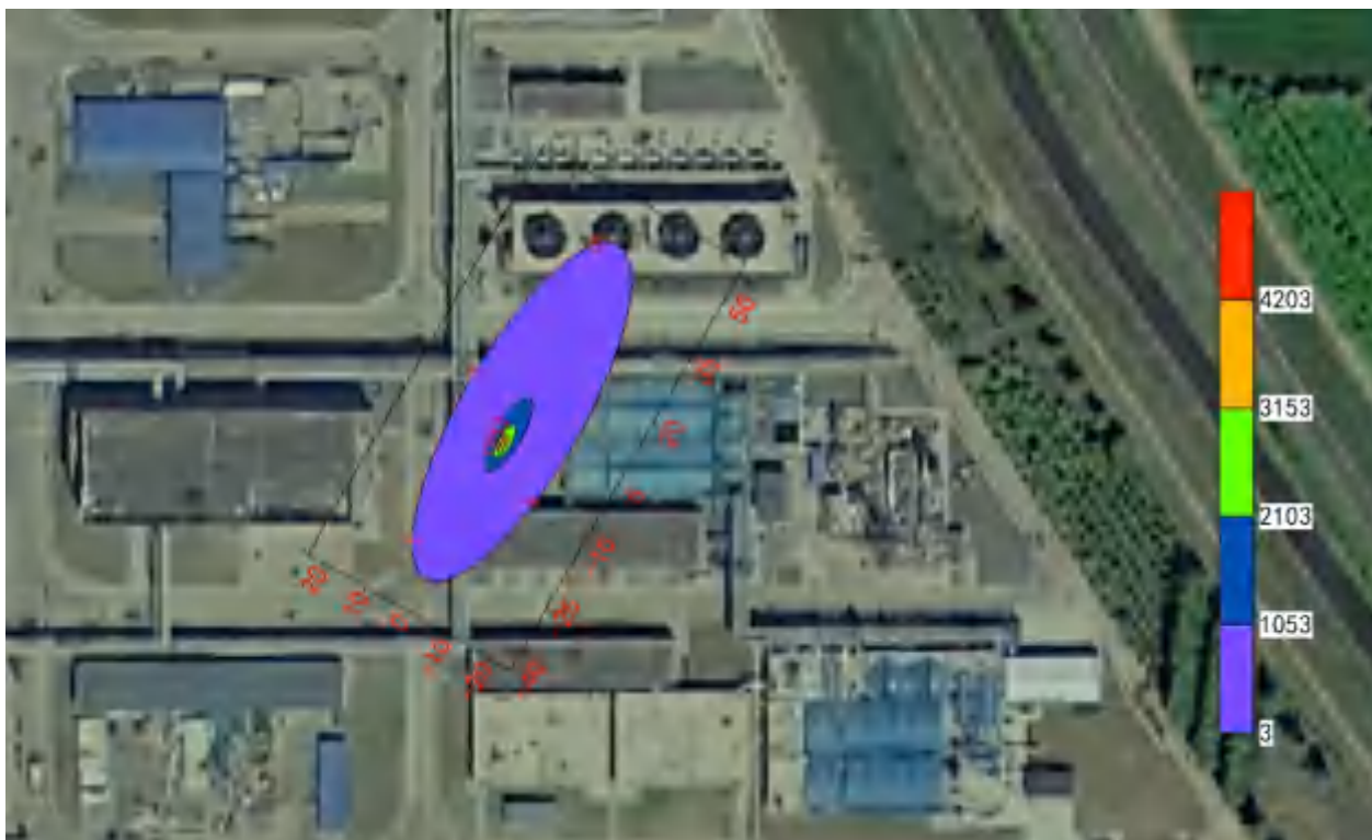
图 5-16 长期泄露 1000d, COD 在地下水中污染范围示意图
