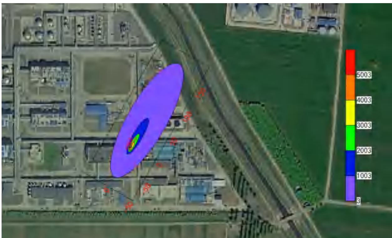
图 5-17 长期泄露 7300d, COD 在地下水中污染范围示意图
