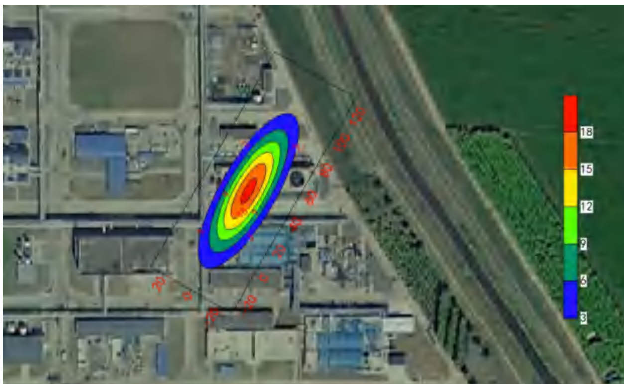
图 5-20 瞬时泄漏 7300 天后 COD 污染范围示意图
