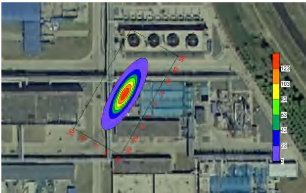
图 5-19 瞬时泄漏 1000 天后 COD 污染范围示意图
